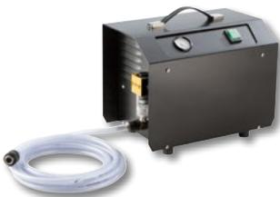
**Vakuumpumpe**, für Vakuum  $\leq -900$  mbar (90%), bestehend aus trockenlaufender Drehschieberpumpe, ölfrei, Förderleistung 6 m<sup>3</sup>/h, Kondensatormotor 230 V, 50–60 Hz, 250 W, spritzwassergeschützt, innenliegender Ansaugfilter mit Schalldämpferfunktion und 5 m PVC-Gewebeschlauch mit Schnellkupplung.
