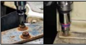
La force d'impact libère les vis rouillées ou gelées sans les endommager. Poignée avec 2 zones moletées antidérapantes pour une prise solide et sûre. Pratique, il s'utilise n'importe où, puisqu'aucune source d'alimentation externe n'est requise.
