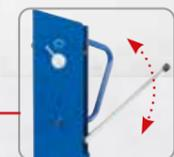
Lever avec système hydraulique pour contrôler l'écartement des rouleaux entraînant la levée et l'abaissement de la roue.
