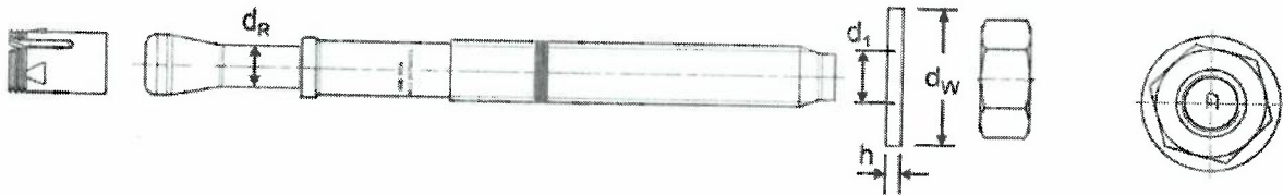
Rysunek A2: Metalowa kotwa rozprężna Hilti HSA-BW
