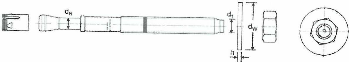
Rysunek A2: Metalowa kotwa rozprężna Hilti HSA-BW
